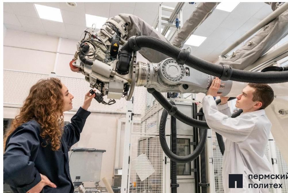
ПНИПУ - клиент и член Пермской ТПП с 2004 года. На фото: настройка робота для выкладки изделий из композиционных материалов для авиационной промышленности
